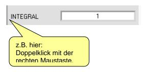
Um zur Offsetkalibrierung zu gelangen, muss in der Registerkarte **PARA** ein Doppelklick mit der rechten Maustaste links neben **INTEGRAL** durchgeführt werden
