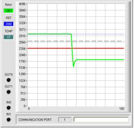
Wenn der aktuelle Messwert RAW (grüne Linie) die Schaltschwelle (rote Linie) unterschreitet, wird der Ausgang OUT0 0V (Fehler). Dies wird über die LED OUT0 visualisiert
